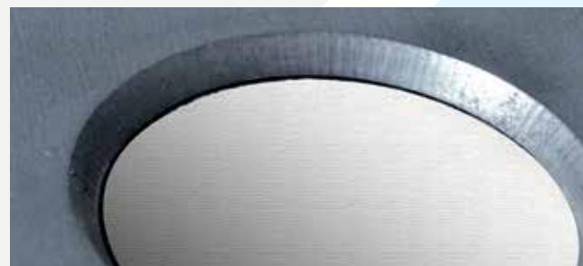
Mit der 5-Achsen-Laser-Fasenkopf-Anlage lassen sich bei Göcke Umformtechnik komplizierte Konturen und Fasen bis 52° problemlos fertigen, optimale Voraussetzungen für spätere Schweißvorgänge. Die glatten, gratfreien Schnittkanten der Werkstücke sind optimale Voraussetzung für einwandfreie spätere Schweißvorgänge.
