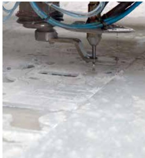
Hochdruck-Wasserstrahlschneiden ist ein ergänzendes Trennverfahren der traditionellen, mechanischen und thermischen Methoden. Da dem Material beim Wasserstrahlschneiden keine Wärme zugeführt wird, lassen sich Stahl, Aluminium, Buntmetall, Stein, Glas, Kunststoff oder Dichtungswerkstoffe problemlos verarbeiten.
